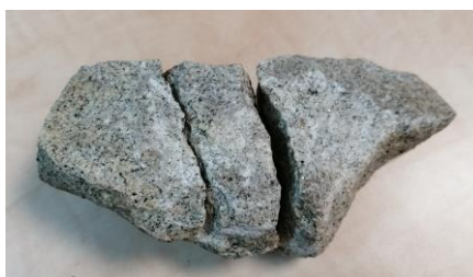
Tento kámen byl ve šneku takto rozlámán. Dovedete si představit, jak se musí celé zařízení ničit, když to musí rozlámat takový kámen !!!
